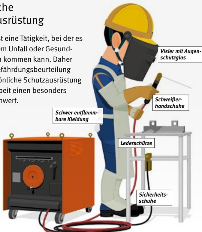
stimmtes Augenschutzglas gegen optische Strahlung enthalten“, betont Zschiesche. Besonders kritisch ist die UV-Strahlung beim Lichtbogenschweißen, da sie zu sonnenbrandähnlichen Hauterkrankungen führen kann. Auch das Verblitzen der Augen ist möglich.
